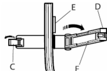
3. Die Kräusler-Führung schliessen (D) und das Ganze sichern, indem sie den Haken schliessen (C). Stellen Sie sicher, dass das Gummiband wirklich in der Aussparung liegt. Stellen Sie die Führung (H) ein, indem Sie den Schieber an die linke Seite des Gummibandes schieben.
