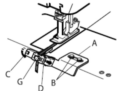
4. Legen Sie den Stoff unter den Nähfuss, mit der Rückseite nach oben. Drehen Sie das Handrad der Maschine, um die Nadel in den Stoff und ins Gummiband zu stechen. Machen Sie eine Probenahrt.
