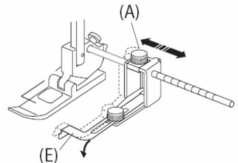
4. Lockern Sie die Schraube (F) und stellen Sie Position der Führung (E) nach vorne oder nach hinten ein, je nach Näharbeit. Die empfohlenen Einstellungen sind:
