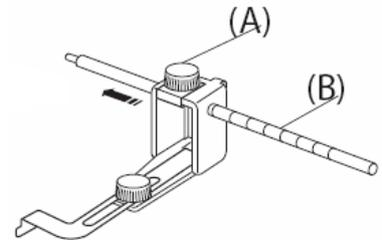
2. Heben Sie den Nähfuss an. Lockern Sie die Schraube (C) und führen Sie die Stange (B) in das hintere Loch des Nähfusses ein. Ziehen Sie (C) an, um die Führung am Nähfuss zu befestigen.
