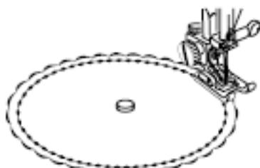
**NOTA:** I tessuti leggeri o di medio peso necessiteranno di uno stabilizzatore per cucire correttamente curve o circoli.
