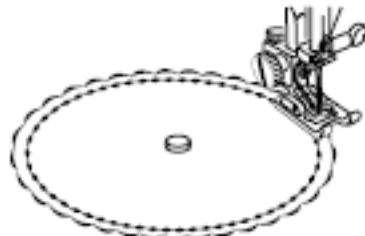
La pointe de pivot pour couture circulaire est insérée dans la table de couture et fournit un point de pivot permettant de coudre de parfaits cercles ou courbes sur des napperons ou de grands festons. Coudre avec des points utilitaires ou des points déco.
