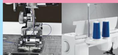
Genial durchdacht und praktisch ist dieser automatische Einfädler. Mit einem Handgriff ist die Maschine eingefädelt und nähbereit. Als Sonderzubehör gibt es den speziellen Garnrollenhalter, entworfen für den Einsatz von industriellen Garnkonen.
