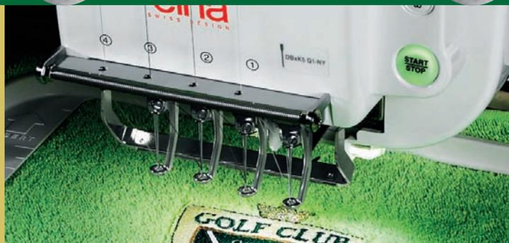
Alles ganz automatisch! Die Elna 9900 wechselt selbstständig zu der Nadel mit der gewünschten Garnfarbe.
