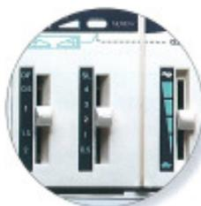
L'écran LCD indique où régler le transport différentiel et la longueur du point
