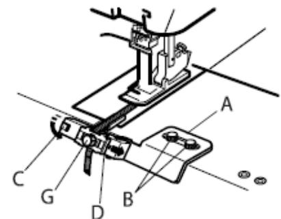
4. Placer le tissu sous le pied, l'endroit au dessus. Tourner le volant à la main pour piquer l'aiguille dans le tissu et dans l'élastique. Faire une couture d'essai.
