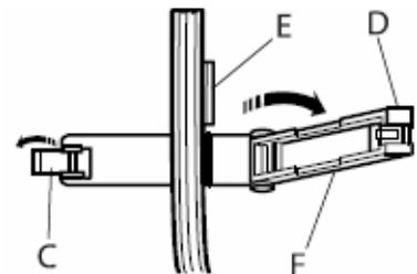
3. Fermer la plaque du fronceur (D) et sécuriser le tout en refermant le crochet (C). S'assurer que l'élastique est bien dans la rainure (F). Régler le guide (H) en le clissant avec son doigt pour que le bord gauche de l'élastique soit maintenu.
