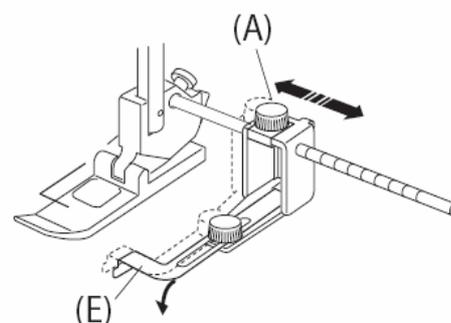
4. Desserrez la vis (F) et réglez la position du guide (E) vers l'avant, ou vers l'arrière suivant votre ouvrage. Les réglages conseillés sont :
