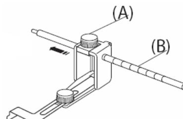
2. Levez le pied à coudre. Desserrez la vis (C) et insérez la barre (B) dans le trou à l'arrière du pied à coudre. Vissez (C) pour serrez le guide au pied.
