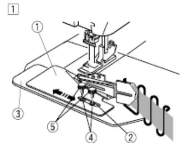
[2] Alignez le biais plié et les aiguilles en faisant glisser le guide de gauche à droite. Lorsque la position est bonne, serrez les vis de fixation.
